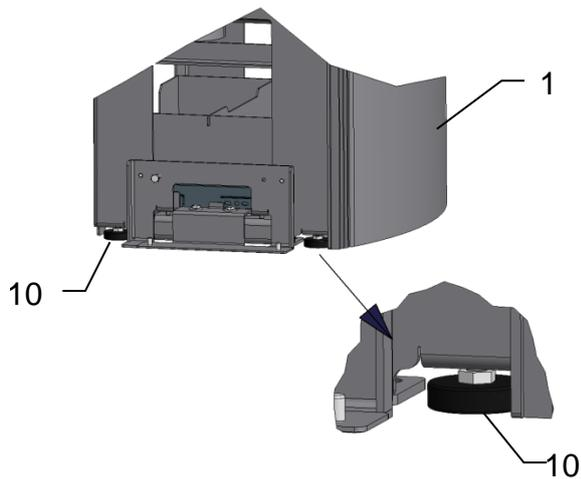
bringen und mit Wasserwaage auf waagrechte Position prüfen.
