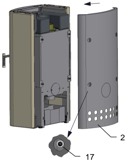
Die Rückwand (2) von hinten auf die vier Gewindebolzen stecken und mit Beilagscheiben und Hutmuttern (17) verschrauben.
