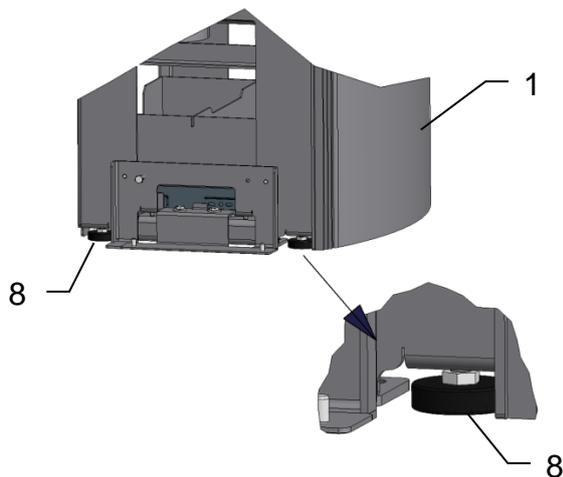
Kaminofen (1) an den Aufstellungsort bringen und mit Wasserwaage auf waagrechte Position prüfen.
