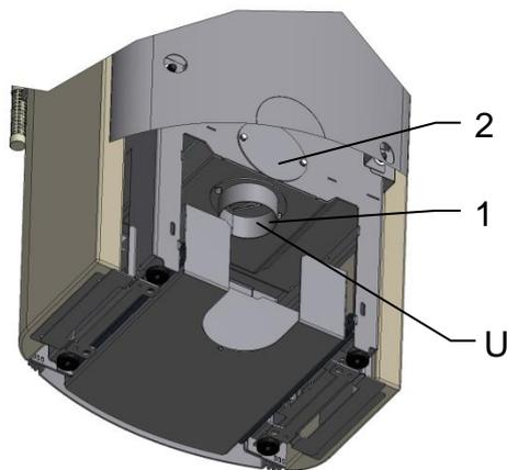
Je nach Ausführung des Kaminofens müssen vorbereitete Ausbrüche vorgenommen werden, oder spezielle Bauteile montiert werden.
