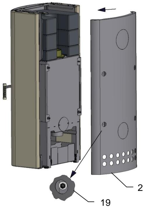
Die Rückwand (2) von hinten auf die vier Gewindebolzen stecken und mit Beilagscheiben und Hutmuttern (19) verschrauben.
