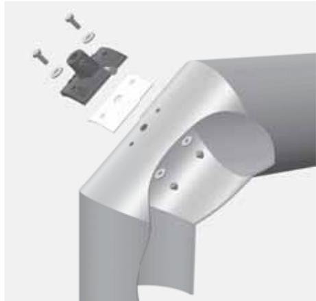
Abb. 3.1 Position des Thermoelements bei senkrechtem Heizgasstutzen
