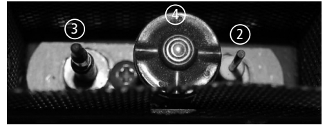
Abb. 7.1 Flammenwächter, Pilot-Brennerdüse und Zünddorn
