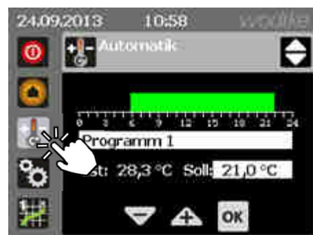
Abb. 11: Hauptmenü Heizbetrieb Automatik
