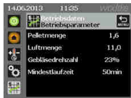
Abb. 56: Menü Betriebsdaten Betriebsparameter
