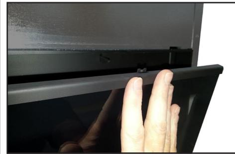
Schließen der Tür nach der Reinigung. Drücken Sie die Tür vorsichtig (aber nicht zu leicht) an die Haken. Überprüfen Sie, ob alle Haken eingerastet sind.
