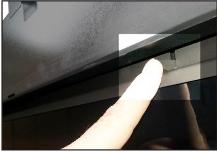
Über dem Glas (unter dem oberen Rahmen) sind Haken. Drücken Sie diese mit Ihren Fingern nach oben. Die Sichtscheibe kann nun bis zu einem Winkel von 45 ° nach vor geklappt werden.
