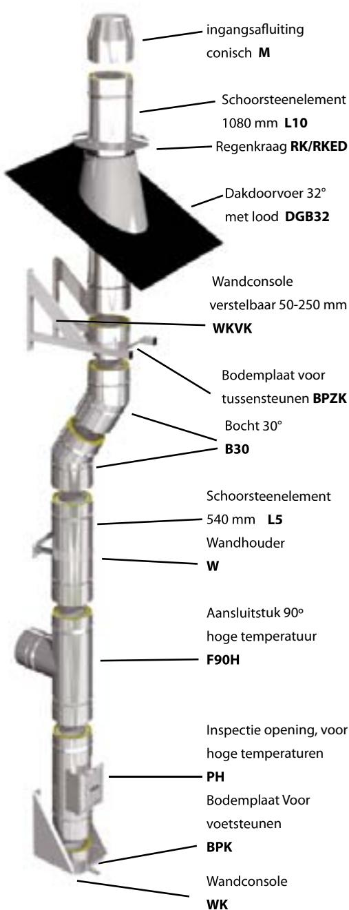
Het afvoerkanaal dient minimaal om de 4 meter te worden gebuigd middels wandbeugels. Er dient niet meer dan 3 meter boven de laatste beugel te worden gemonteerd. Anders zijn tuidraden of een tuibeugel van toepassing.
