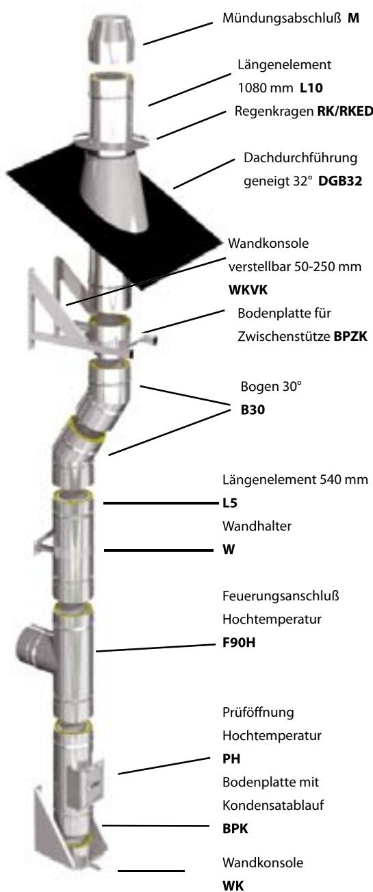
lage auf ein Sockelelement oder einen bauseitigen Sockel aufzubauen. Die Abgasanlage darf schräggeführt werden. Zulässig sind Schrägführungen bis max. 90° (empfehlenswert max. 45°). Oberhalb der **Schrägführung** ist eine Zwischenstütze erforderlich, wenn die Höhe der Abgasanlage mehr als ca. 1 m beträgt, andernfalls genügt ein Wandhalter.
