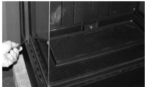
Abb. 2.9 Bei der ES- oder PS-Variante die Abdeckungen der seitlichen hinteren Scheibenleisten mit einer flachen Schraubendreherklinge vorsichtig heraushebeln.
