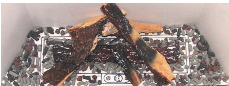
Abb. 2.39 Einlegen der Scheitholzimitate beim CARISMO 63 DB Front Flüssiggas
