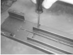
Abb. 2.21 Umbau von G20 auf G25
