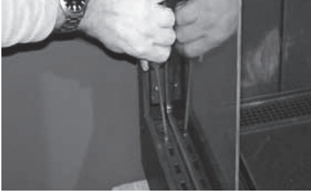
Abb. 2.10 Die seitlichen unteren Scheibenleisten demontieren.
