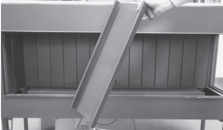
Abb. 2.12 Ausgebaute Prallplatte bei ES und PS Geräten
