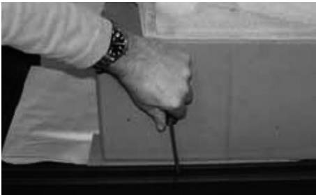
Abb. 2.6 Schrauben der unteren Scheibenleiste mit Hilfe eines Innensechskantschlüssels lösen. (Bsp. CARISMO 63 ES L)
