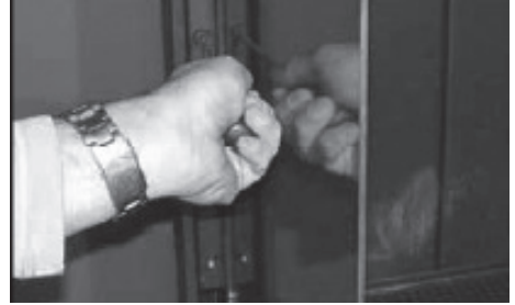
Abb. 2.11 Die seitlich hinteren Scheibenleisten entfernen.
