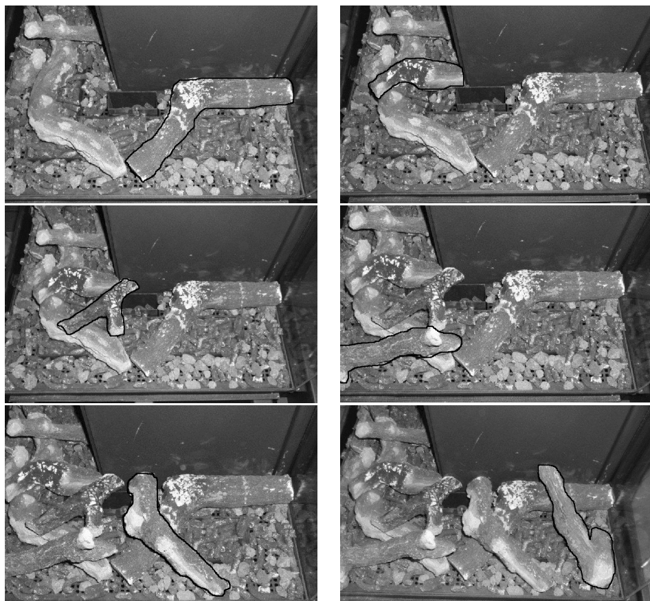
Abb. 2.57 Einlegen der Scheitholzimitate im CARISMO 2050.
