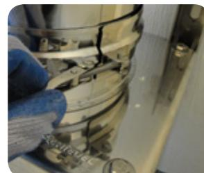
**3.** Klemmband über die Sicke schließen und kraftschlüssig verschrauben.
