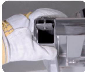
**3.** Schutzkappen zur weiteren Montage abziehen und Gewindeplatten in Grundplatte einschieben. Vorerst nur leicht verschrauben!
