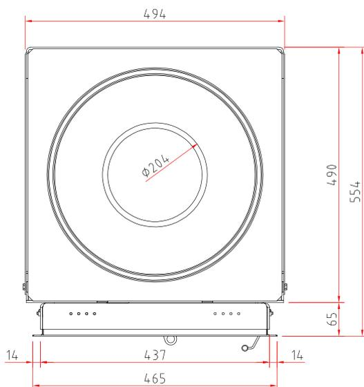
Seitenansicht Drehzug für Wand- oder Deckenanschluss M 1:20
