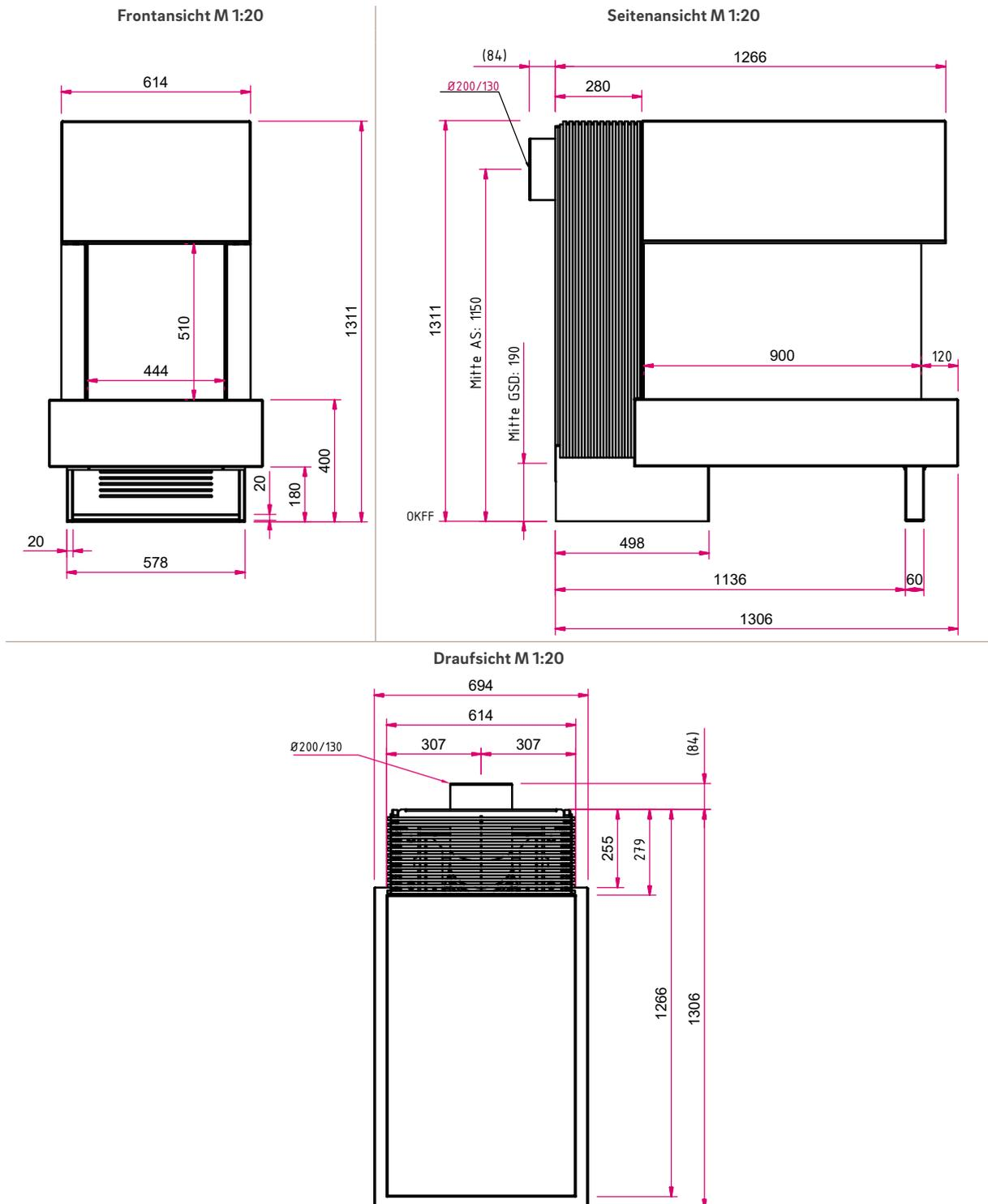
**Achtung:** Eine 230 V Anschlussleitung mit mind. zwei Schuko Steckdosen muss im Inneren der Anlage vorgesehen werden! Anlage nur mit Wandanschluss möglich!
