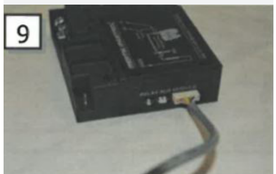
Abb. 2.16 Anschluss der LED-Beleuchtungseinheit
