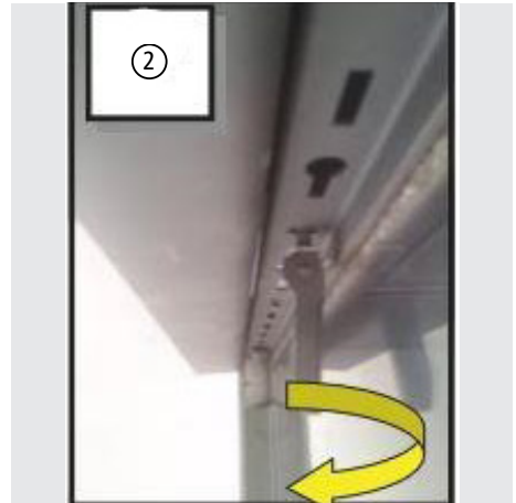
Abb. 2.5 Herausdrehen der Schnellverschlüsse
