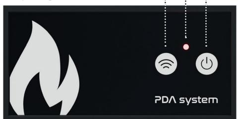
Drücken Sie auf der Fernbedienung gleichzeitig etwa 10 Sekunden lang Zurück (↶) und Ein / Aus (🔌), bis sich die Funksteuerung wieder einschaltet und Sie die Sprache auswählen können.
