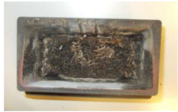
BEISPIEL VERSCHMUTZTE BRENNSCHALE
