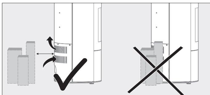
Abb. 3.2 Konvektionsluftöffnungen freihalten
