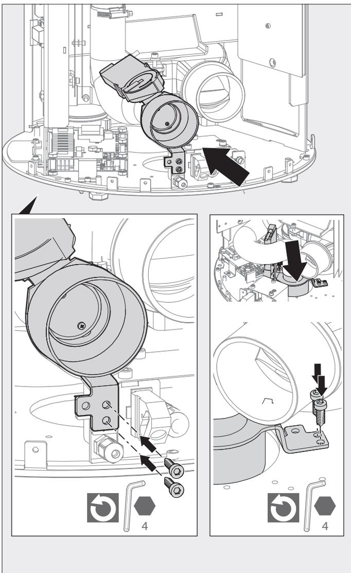
Abb. 2.23 Untere Rückwand und mitgelieferte Blende montieren
