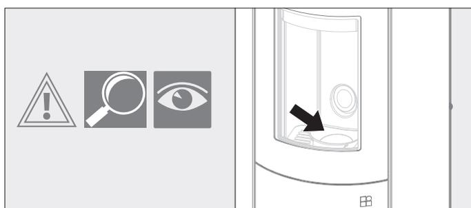
Abb. 3.3 Sichtprüfung Brennermulde
