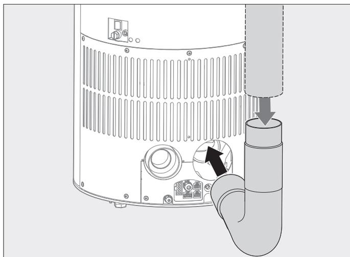
Abb. 2.14 Abgasrohr (bauseitig) auf Anschlussstutzen stecken
