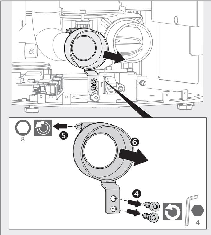
Abb. 2.17 Verbrennungsluftstutzen abschrauben
