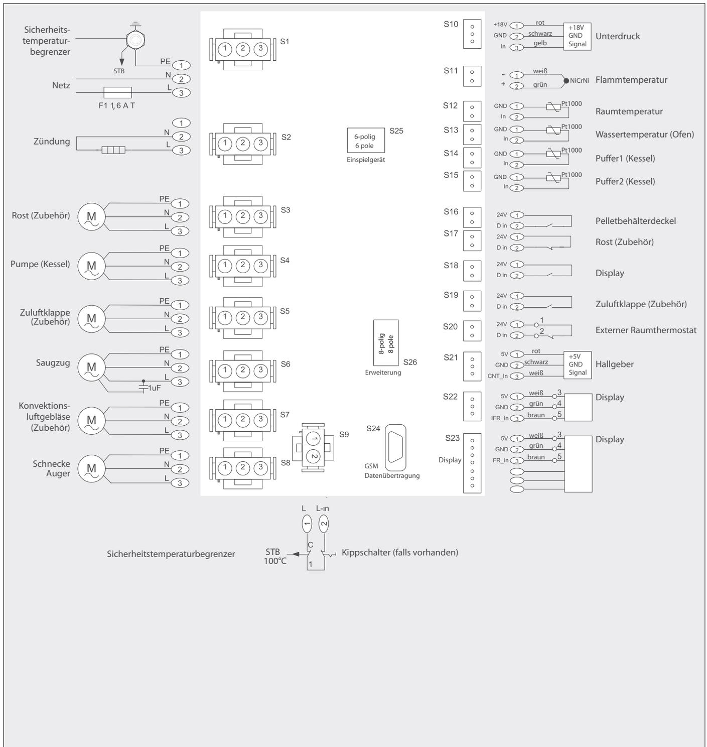
Abb. 2.40 Elektrischer Anschlussplan
