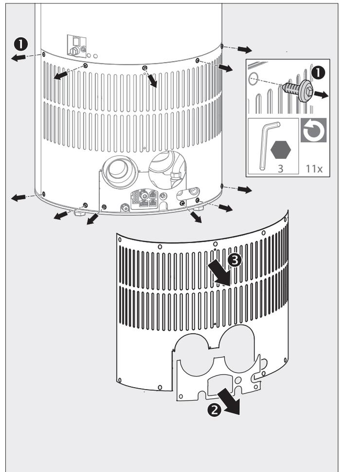
Abb. 2.21 Untere hintere Rückwand und Blende demontieren
