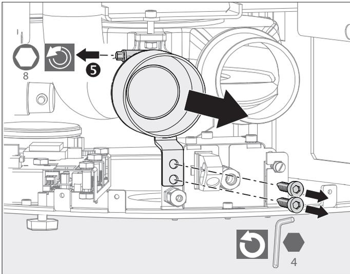
Abb. 2.22 Verbrennungsluftstutzen abschrauben
