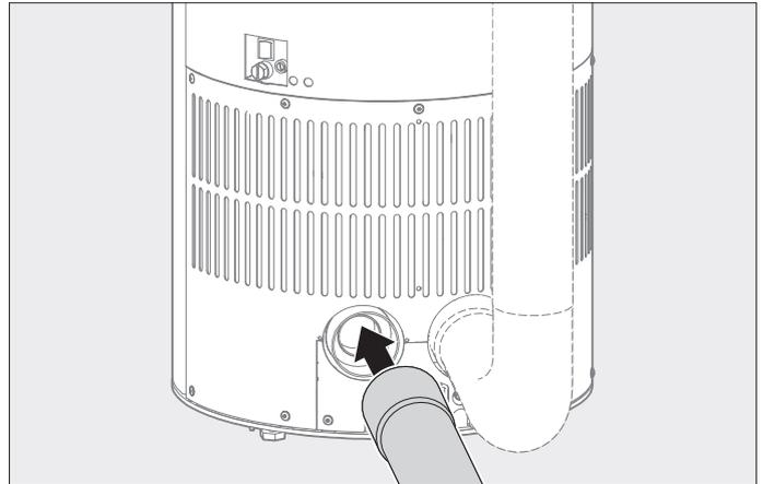
Abb. 2.15 Verbrennungsluftleitung  $\varnothing$  80 mm hinten aufstecken
