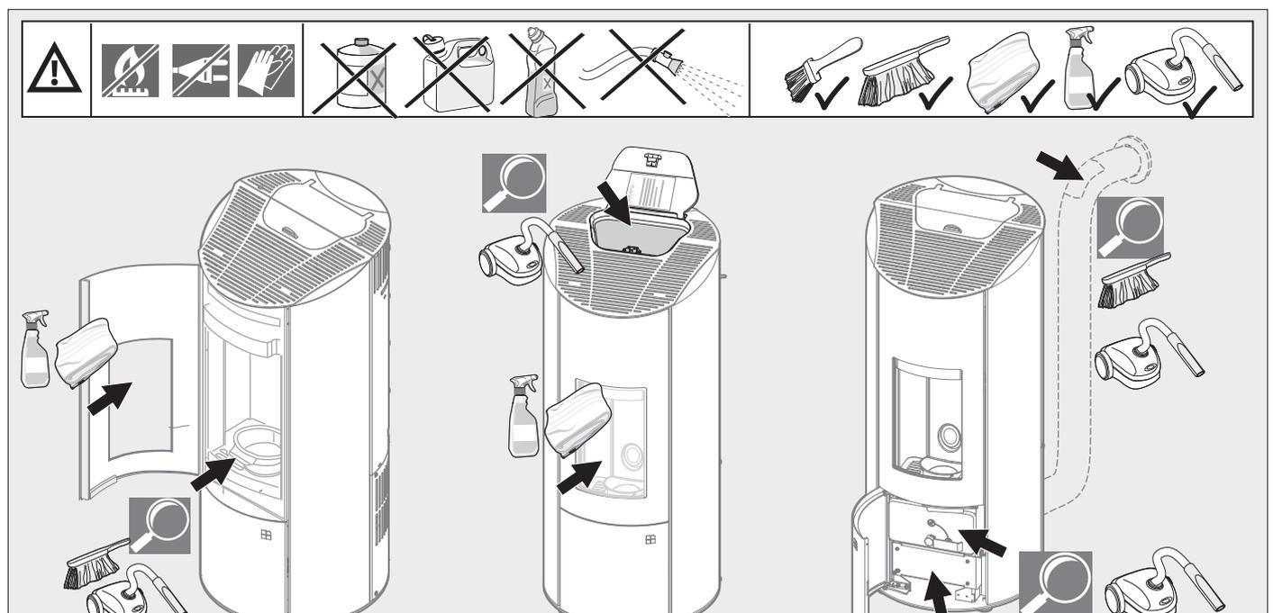
Abb. 4.1 Reinigungsübersicht/Reinigung durch den Betreiber
