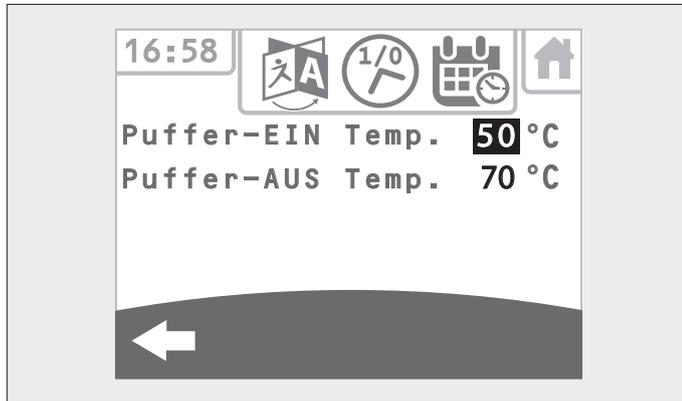
Abb. 3.19 Touch-Bedienfeld – Anzeige bei LEVANA AQUA, Puffer EIN/AUS
