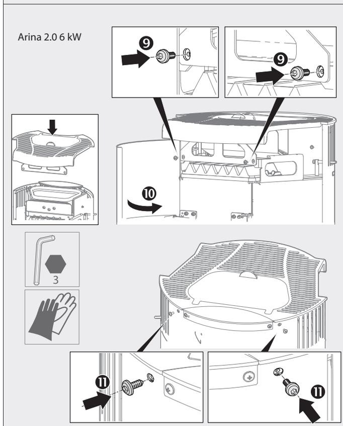
Abb. 2.34 Obere Abdeckung wieder aufsetzen und verschrauben
