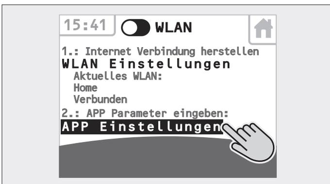
Abb. 3.45 Bei bestehender WLAN Verbindung App Einstellungen wählen
