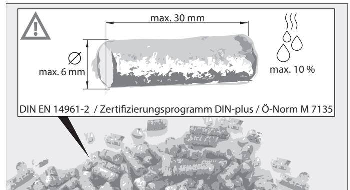
Abb. 3.4 Nur zulässige Pellets in den Pelletbehälter einfüllen
