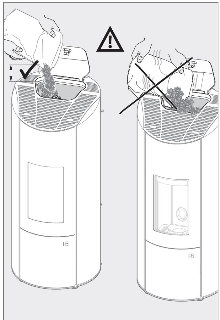
Abb. 3.8 Pelletsack beim Einfüllen nicht auf heiße Oberflächen legen
