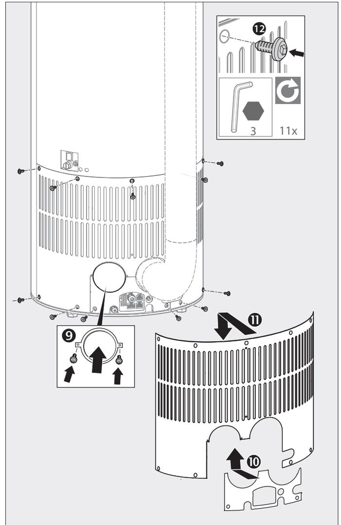
Abb. 2.24 Untere Rückwand und mitgelieferte Blende montieren
