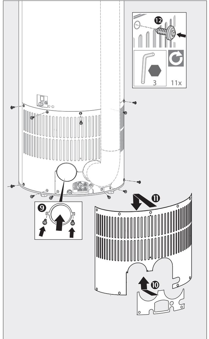
Abb. 2.19 Untere Rückwand und mitgelieferte Blende montieren
