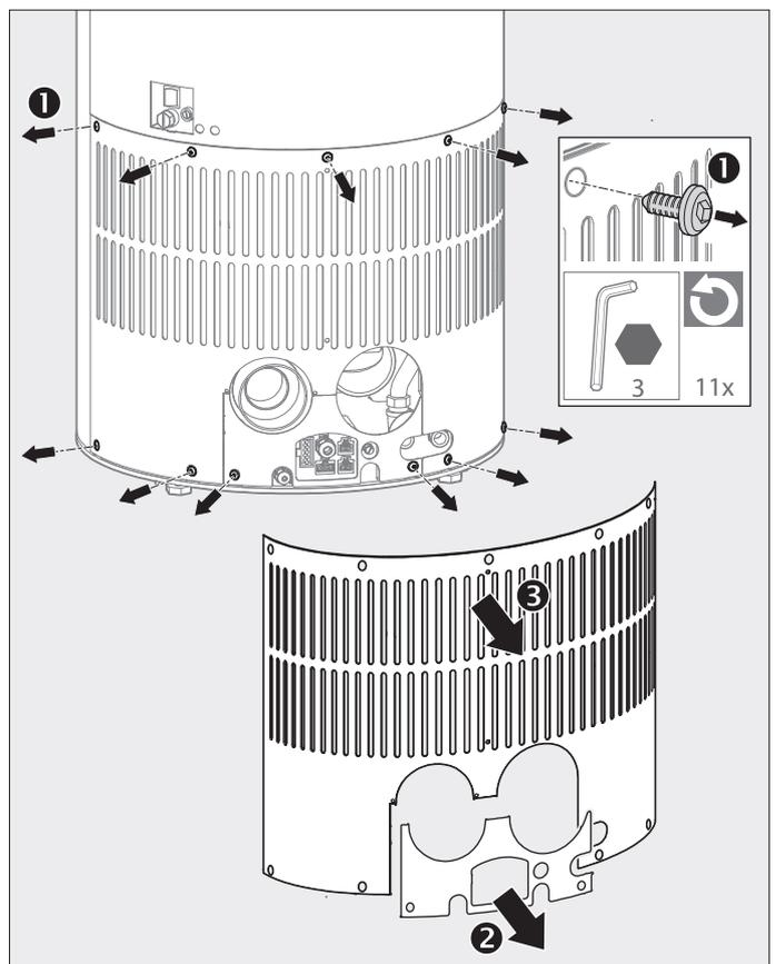
Abb. 2.16 Untere hintere Rückwand und Blende demontieren
