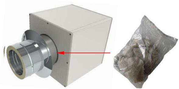
8. Abgasanlage durchführen und den verbleibenden Ringspalt zwischen ein- und doppelwandiger Abgasanlage mit der im Lieferumfang enthaltenen Stopfwole zentrieren und im Randbereich auf beiden Seiten dicht ausstopfen!
