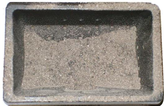
Fig. 61 - Beispiel einer schmutzigen Brennschale
