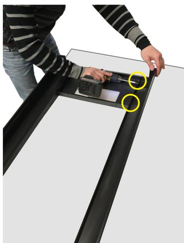
**Fig. 22 - Befestigung des Trägers**
