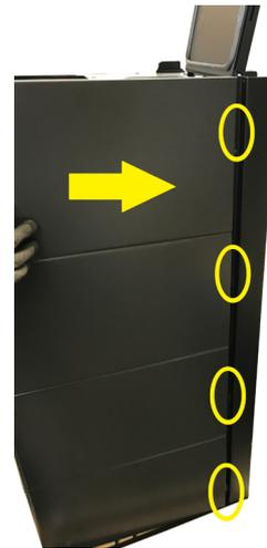
Fig. 35 - Die Seitenwand einhängen
