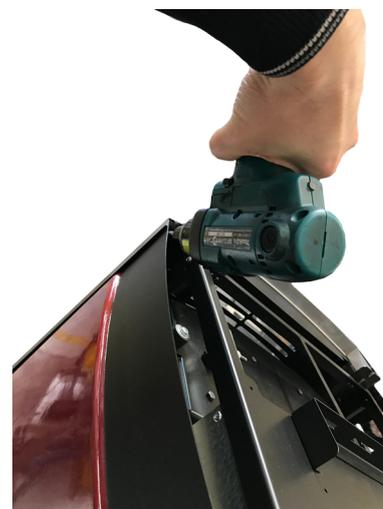
**Fig. 33 - Den Ausgleich befestigen**
