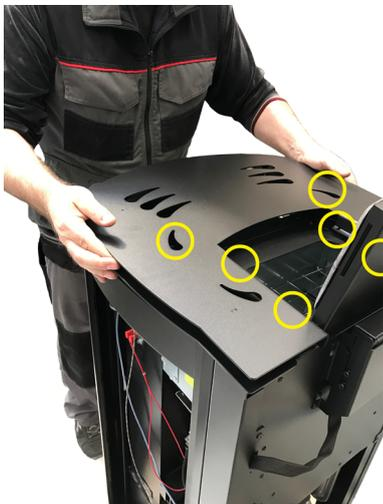
**Fig. 28 - Entfernen der Abdeckung**
