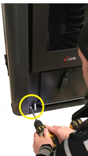
**Fig. 25 - Befestigung des Rahmens**
