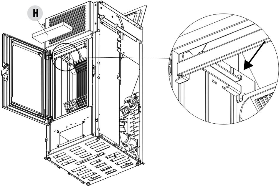
Mit der Staubsaugerdüse Asche und Staub, die sich über dem Wärmetauscher angesammelt haben, absaugen (siehe Pfeil).
