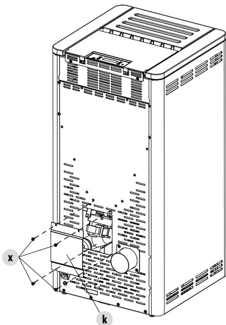
Um Zugang zum Getriebemotor zu erhalten, müssen die vier Schrauben „x“ an der Rückwand des Ofens und die Platte „k“ entfernt werden.
