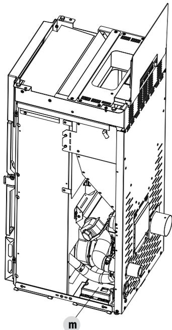
Die Platine „m“ befindet sich auf der rechten Seite (Griffseite). Falls der Zugang zur Platine erforderlich ist, die hintere Seitenwand wie in den vorigen Abschnitten beschrieben abnehmen.
