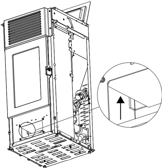
Dann das obere Teil aus Calorite „H“ herausnehmen, dazu die Brennkammertür öffnen und oben mit den Händen die Calorite-Platte „H“ nach oben anheben und nach rechts oder links neigen, um sie aus den Halterungen zu lösen, und herausnehmen.
