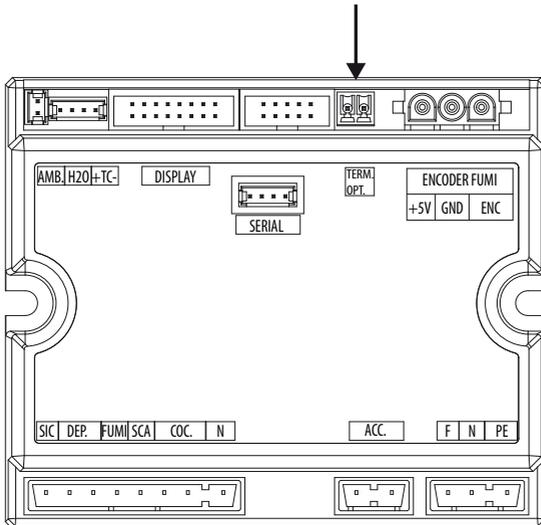
Die Temperatur des Ofens kann auch durch einen externen Raumthermostaten geregelt werden. Dieser wird in einer mittleren Position hinsichtlich des Installationsraums angebracht und sorgt für eine geringere Abweichung zwischen der vom Ofen geforderten und der tatsächlich von diesem gelieferten Heizungstemperatur.
