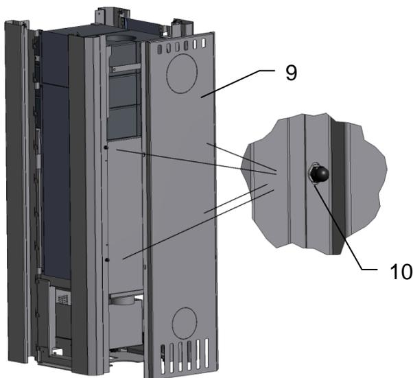
Die Rückwand (9) von hinten auf die 4 Gewindebolzen stecken und mit Scheiben und Hutmuttern (10) anschrauben.
