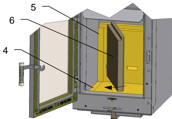
Den linken unteren Seitenstein (6) in den Falz des Rückwandsteins (5) einfahren und nach außen schieben, bis dieser in den Falz der Bodenplatte (4) einrastet.
