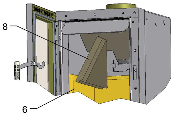
Den linken oberen Seitenstein (8) in den Falz des linken unteren Seitensteins (6) aufsetzen.
