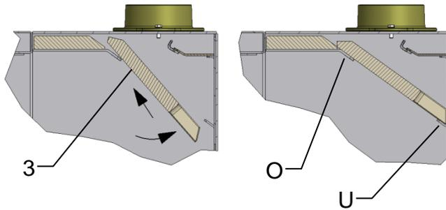
Umlenkplatte (3) wie abgebildet in den Brennraum einfahren und auf den oberen (O) und hinteren (U) Aufwinkeln ablegen.
