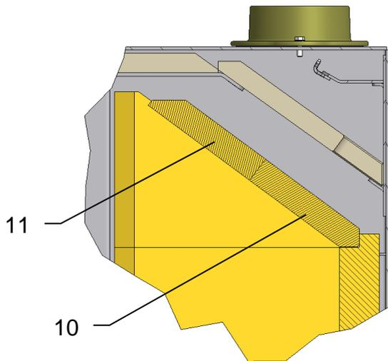
Die hintere (10) und die vordere (11) Deckelplatte wie abgebildet mit Falz nach unten in den Feuerraum einsetzen.
