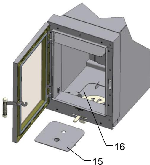
Zum Reinigen der Brennkammer die Schamottesteine ausbauen.
