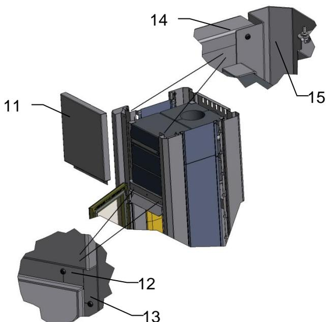
Die Frontblende (11) mit den Linsenkopfschrauben (12) an die Frontplatte (13) schrauben. Oben die Frontblende (11) mit Linsenkopfschrauben (14) mit den Eckprofilen (15) verbinden.
