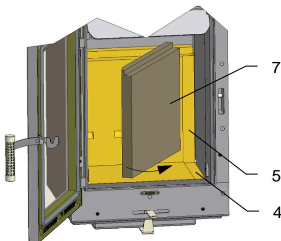
Den rechten unteren Seitenstein (7) in den Falz des Rückwandsteins (5) einfahren und nach außen schieben, bis dieser in den Falz der Bodenplatte (4) einrastet.
