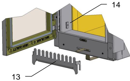
Den Feuerbock (13) in die Führungen (14) am Brennraum einsetzen.
