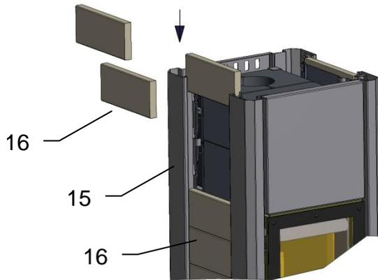
Die Seitensteine (16) mit der Fase nach außen von oben in die Eckprofile (15) einfädeln und nach unten führen.
