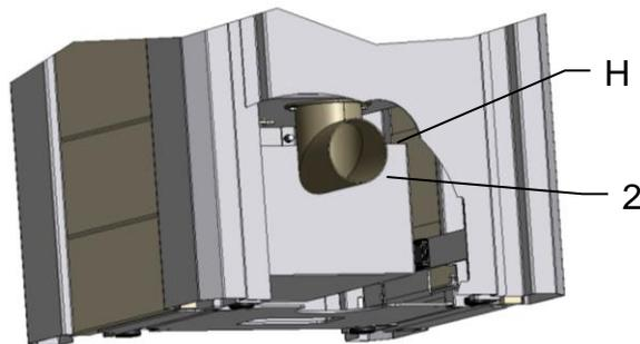
Bei Außenluftanschluß nach hinten (H) erfolgt der Anschluß mit einem abgewinkelten Außenluftstutzen (2).
