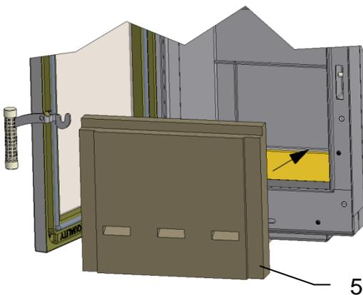
Den Rückwandstein (5) mit Sichtseite zum Feuerraum einsetzen und ausmitteln und ganz nach hinten schieben.
