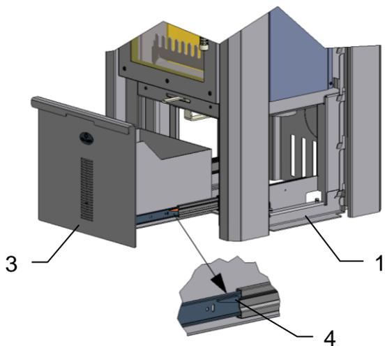
Kaminofen (1) an den Aufstellungsort bringen und mit Wasserwaage auf waagrechte Position prüfen.
