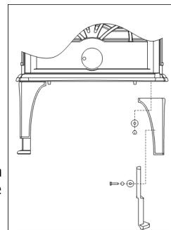
(450) Montieren Sie den Aschenfänger auf der Vorderseite unter der Bodenplatte. Schrauben Sie zwei Gewindeenden (M8x20) in die Bodenplatte, und befestigen Sie den Aschenfänger mit zwei Muttern (M8) und zwei Ringen.
