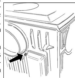
Die Flammplatte ist an die Hinterplatte mit einem Bolzen befestigt (siehe Zeichnung). Nach dem Losschrauben dieses Bolzens kann die Flammplatte einfach aus dem Ofen genommen werden. Entfernen Sie eventuell zuerst die feuerfesten Steine.
