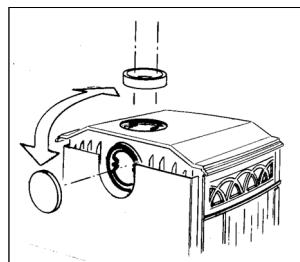
Sorgen Sie für eine gute Abdichtung des Anschlusskragens und Deckels am Gerät, und zwar mit beiliegendem Kit oder Pasta.
