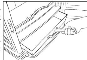
Van hout hebt u relatief weinig assen en is het niet nodig uw toestel elke keer te ontassen, het stoken van hout in een asbed geeft overigens een betere verbranding. Bij kolenstook moet regelmatig ontast worden en de aslade tijdig geledigd worden. De assen mogen de onderzijde van het stookrooster NOoit raken.
