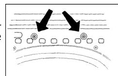
Am Ende der Heizsaison schliessen Sie den Kamin mit Hilfe einer Zeitungspapierkugel ab. Sie können dann den Innenofen gut saubern machen. Ersetzen Sie, falls notwendig, die Dichtungsschnur und dichten Sie eventuelle Brüche mit Kitt. Entfernen Sie gegebenenfalls auch die Flammplatte oben im Herd für eine gründliche Reinigung.
