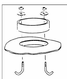
rechterkant van de opening. Zorg voor een goede afdichting van de aansluitkraag op het toestel door middel van de bijgevoegde kit of pasta.
