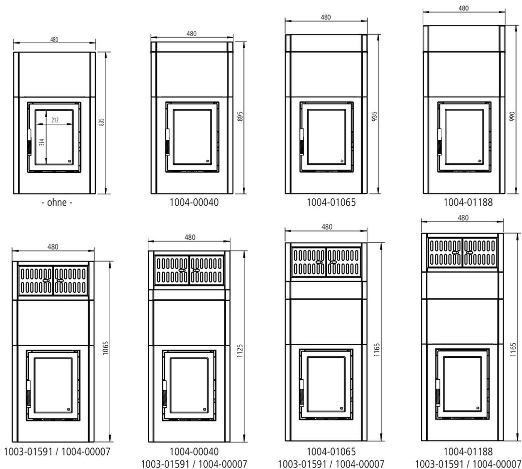
DIAMANT H10 hier: mit Heizgasstutzen 145 mm (1004-01262) / 180 mm (1004-00780) / M1:10
